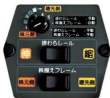
操作パネル 運転席から降りずに 操作できます。
