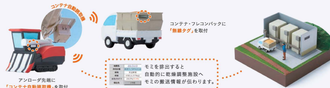
アンローダ先端に「コンテナ自動読取機」を取付
